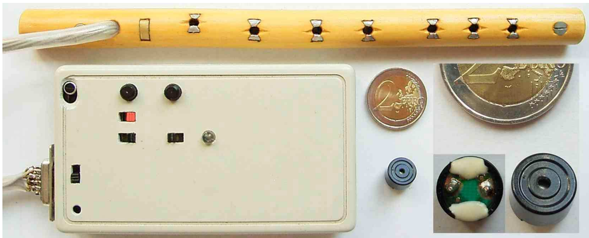
Bild 4: Griffstab aus Holz, modifiziertes Steuergerät und Miniatur-Piepser
