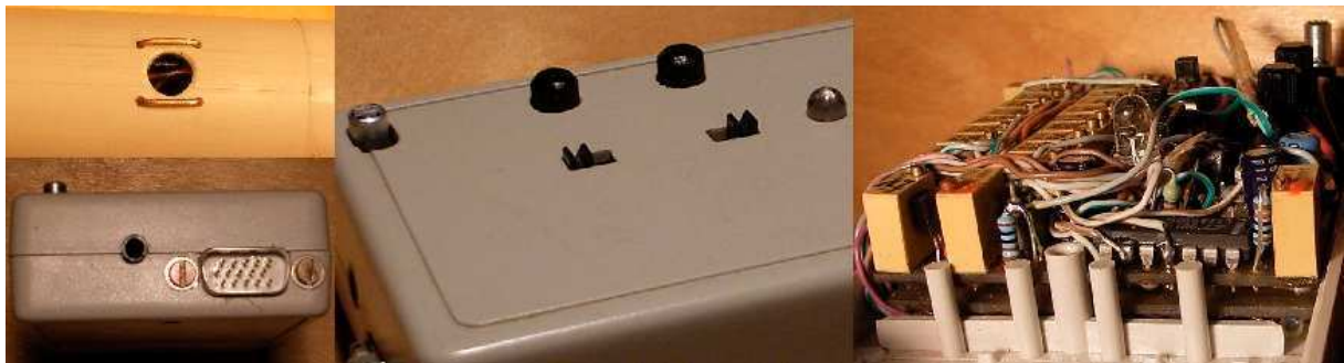
Bild 3: Details: Griffloch, Steckverbindung, Bedienelemente, übereinander liegende Leiterplatten
