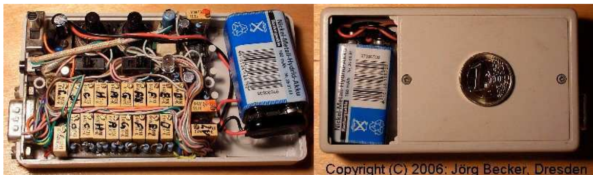
Bild 2: Steuergerät von oben (ohne Deckel) und von unten (offenes Batteriefach)
